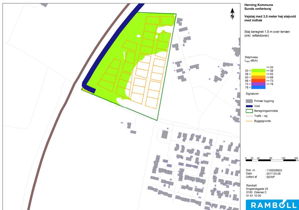
Figur 2: Støjkort for hævet terræn med forlængelse af eksisterende støjvold. Højde af støjvold 3,5 m regnet over terræn.
